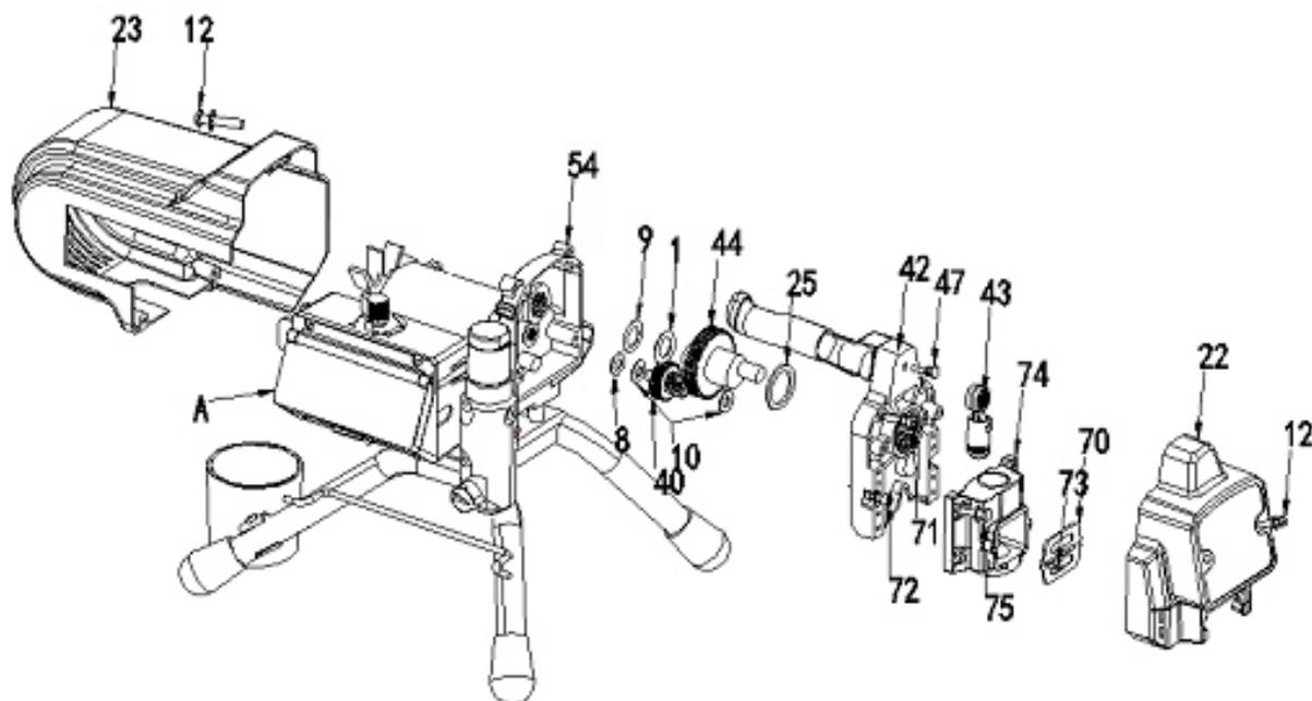
3. Снимите винты (73) и крышку штока насоса (70).
